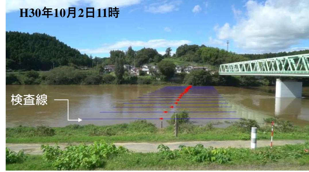
動画カメラで撮影した**20**秒程度の画像から、流下方向に検査線を設定して、時間と距離の時空間画像を作成
