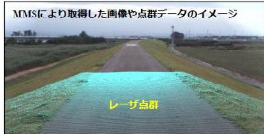
MMSにより取得した堤防周辺の点群データを標高段彩で表示したイメージ
